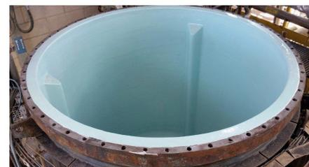
Светлые цвета Belzona 1593 облегчают проверку качества покрытий внутри емкостей.
